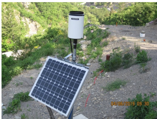
coffret de la centrale d'acquisition avec panneau solaire et pluviomètre
